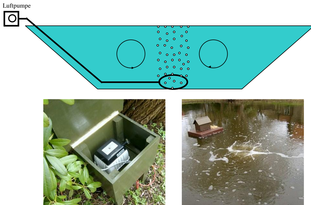
Figur 7. Øverst ses en skitse over et belufts anlæg med luftpumpe placeret på land og én beluftsring placeret i søen. Nederst vises billeder af en luftpumpe i en vejtæt kasse, samt resultatet af beluften på vandoverfladen.
