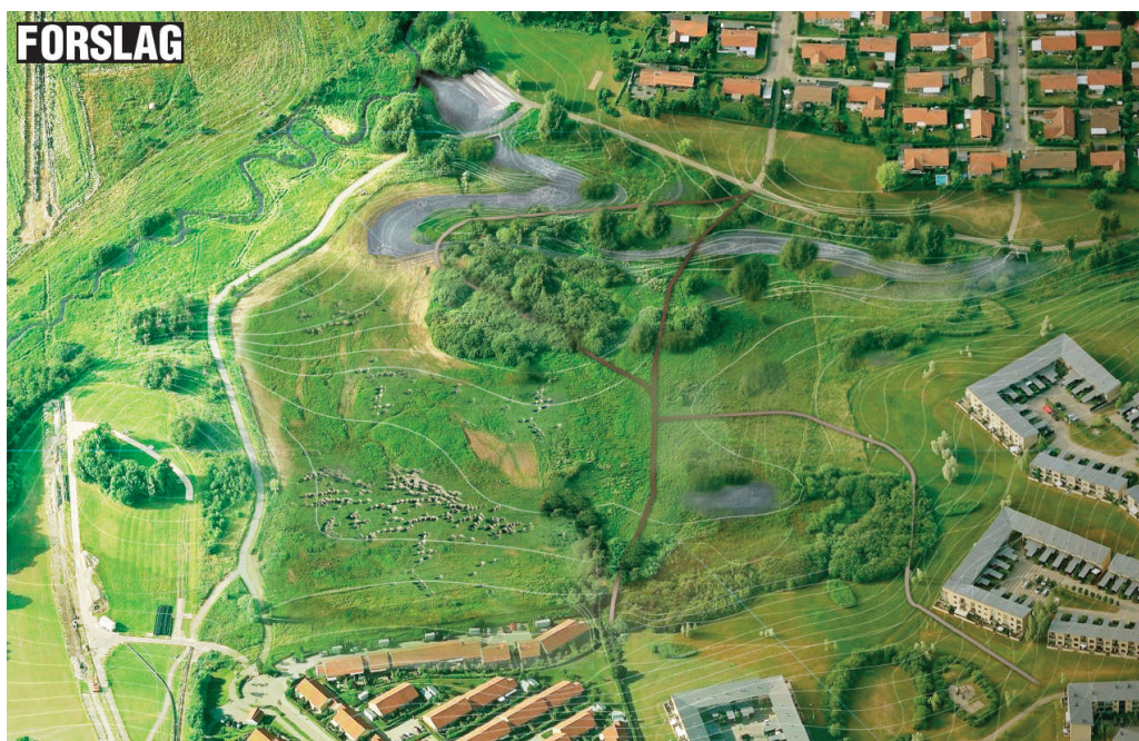
Figur 5. Visualisering af vådengen, ved fuld udnyttelse af magasinvolumen.
