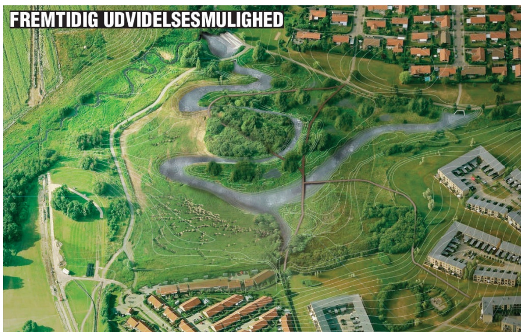
Figur 7. Visualisering af udbygningsmuligheden, ved fuld udnyttelse af magasinvolumen.
